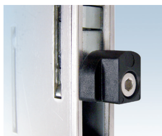
Les bloqueurs des pènes et des pènes dormants sont conçus pour un fonctionnement intuitif. Ils sont conçus pour assurer la communication entre le panneau de porte semi-actif et actif afin que les deux panneaux soient verrouillés dans le bon ordre
